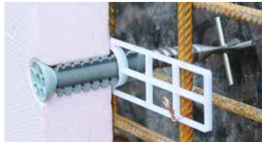
Verwendung des V2A UNI-Betonankers mit Montageplatte und Verlängerungshülse bei Isolationseinlagen in der Schalung.
