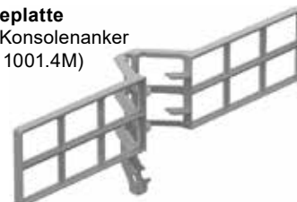
ASK Konsolenanker mit montierter Montage- platte und Verschlusszapfen zur Befestigung an der Bewehrung bei Verwendung an Innen- oder Stahlschalungen (Art. Nr. 1001.4KM)
