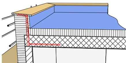
**12** Zum Schluss kann die Fassade verputzt, die Kiesschicht eingebracht und die Blechabdeckung montiert werden.
