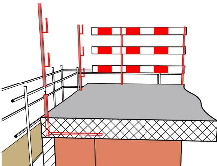
**8** Nachdem das Gerüst hochgezogen ist, kann das Schutzgeländer entfernt, und der Deckschieber auf der gewünschten Höhe fixiert werden.
