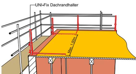
**2** Die Deckenrandabschalung kann danach mit baustellenüblichen Klemmwerkzeugen direkt am UNI-Fix Flachdach-Randhalter befestigt werden.
