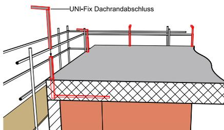
**9** Die Holzverkleidung für den Dachrandabschluss wird am UNI-Fix Flachdach-Randhalter mit selbstschneidenden Schrauben befestigt.
